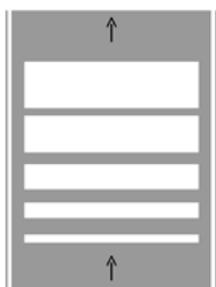
Sulla base delle indicazioni progettuali ovvero della Direzione Lavori, i sistemi di rallentamento ad **effetto acustico** saranno realizzati mediante irruvidimento della pavimentazione stradale ottenuta con la
